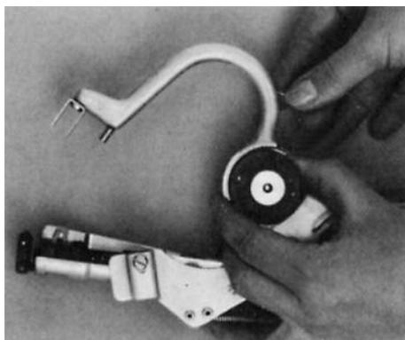
3. Sfilare circa 15 cm di filo metallico ed infilare attraverso la guida del filo metallico e l'ugello.
